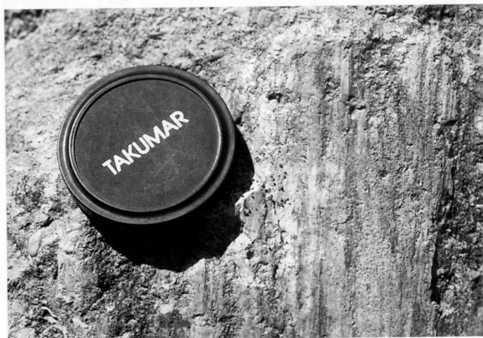
Fig. 4 - Striature da movimento verticale nei conglomerati pontici del M. di Ragogna. - Ragogna Mt.: pontian conglomerate with vertical slickensides.
